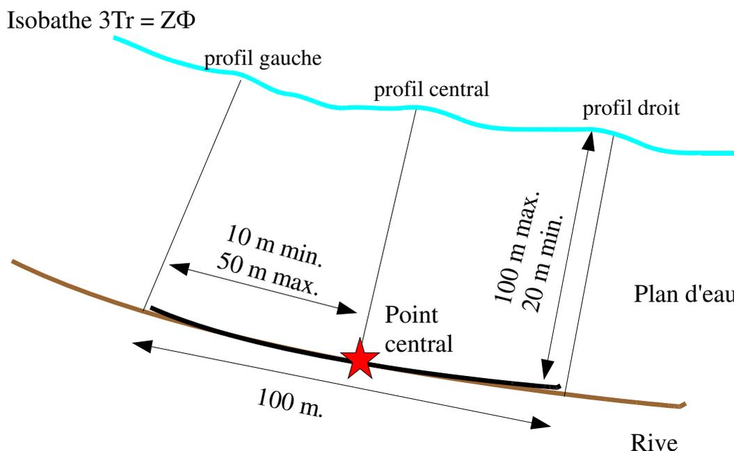
Figure 9 : Représentation schématique d'une unité d'observation
