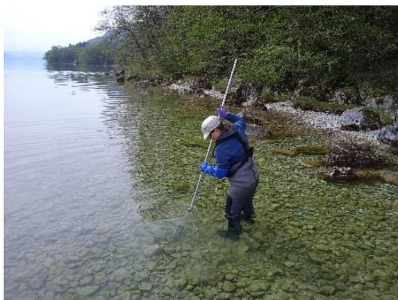
Figure 6 : Echantillonnage IML sur la zone littorale d'un plan d'eau
