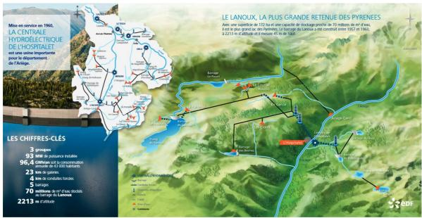
Figure 1 : la retenue du Lanoux au sein de l'aménagement hydro-électrique de l'Hospitalet (plaquette EDF)
